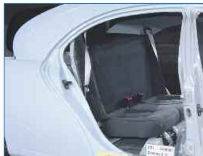
L'autovettura Solaris Quattroporte durante il crash test dei sedili posteriori.
