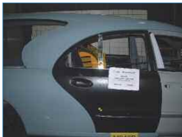
L'autofunebre Solaris Quattroporte durante il crash test dell'ancoraggio delle cinture di sicurezza.
